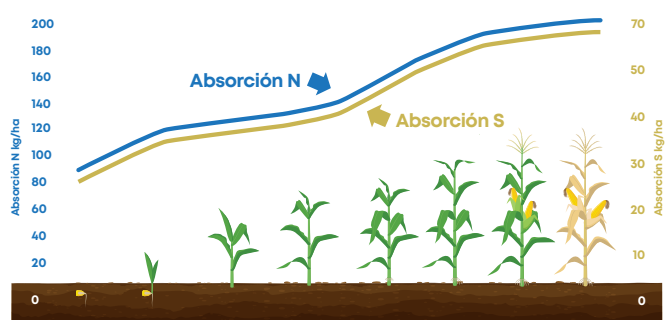
Figura 2. Curva de Absorción de Nitrógeno (N) y de Azufre (S) en kg/ha, en función de la fenología de los cultivos gramíneos.
